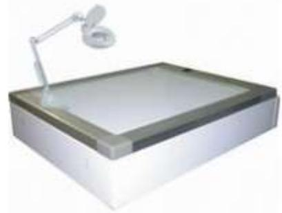
二、使用方法 使用时，需将净度台平放桌子上，所要观察的种子放在台面上，插好电源，打开开关，台面上亮度柔和，放大镜灯从上面照明和放大，可以更清楚的观察种子情况。使用时，也可以将桌子抽屉打开，将观测好的种子直接拔到抽屉里。
